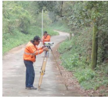
圖 2-8 精密自動記錄水準儀儀器照
