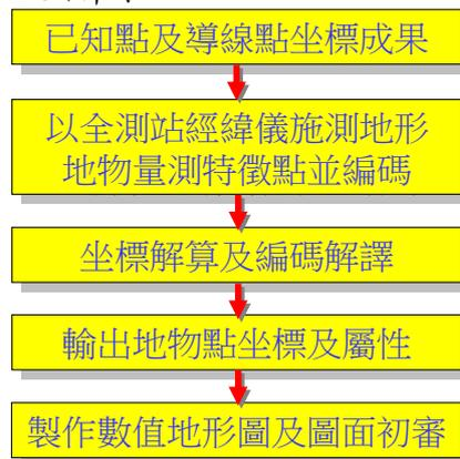
圖 3-10 三次元地形測量作業流程
