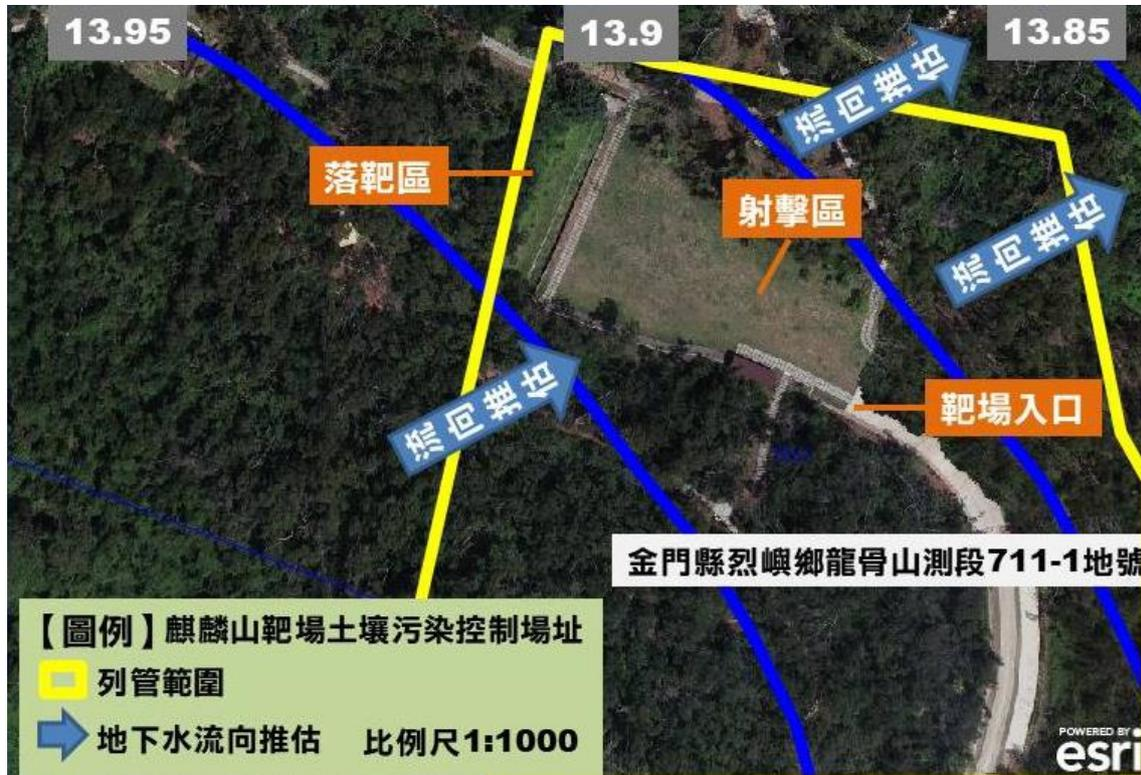
圖 5.4.1-5、麒麟山靶場土壤污染控制場址地下水流向推估圖
