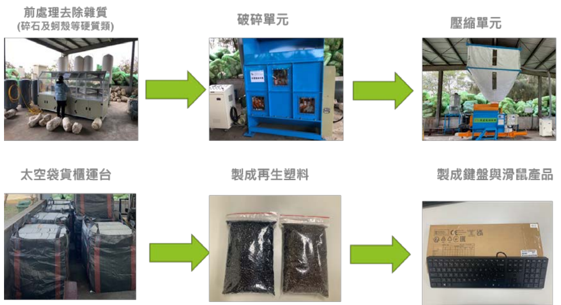
海廢保麗龍冷壓減容設施及後續處理流程
