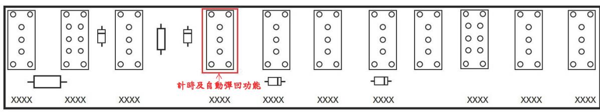
示意圖十 計時器及能使地區音響開關自動彈回之開關板
