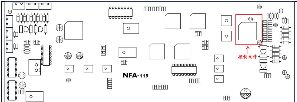
示意圖十二 更換控制元件
