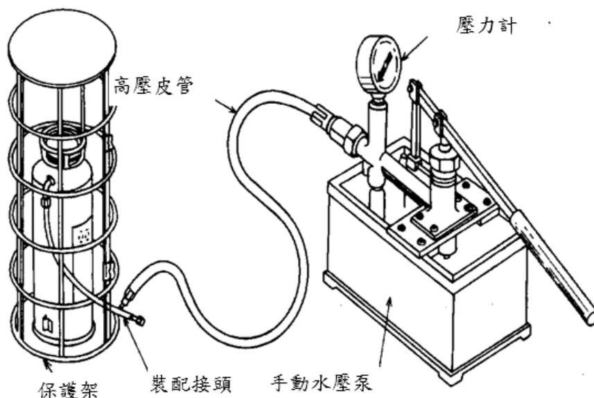
圖 1-6 水壓試驗機及保護架
