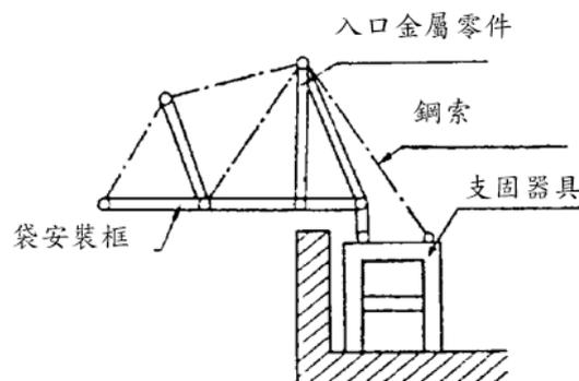
圖18-6 支固器具及入口零件之例
