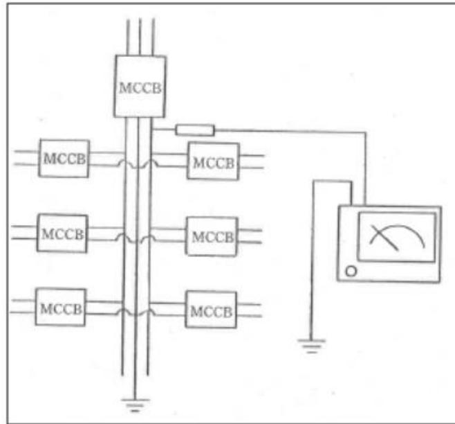
圖 27-2 絕緣阻抗試驗測量時配線圖
