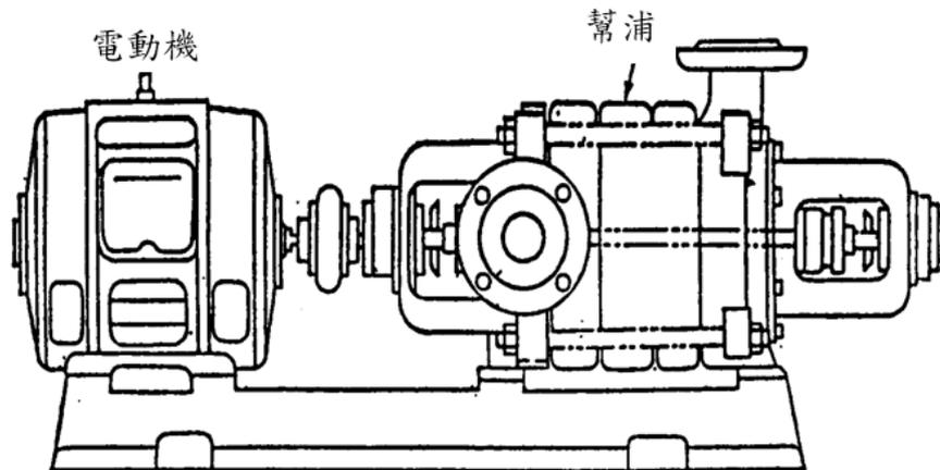
圖 21-1 加壓送水裝置（幫浦方式）
