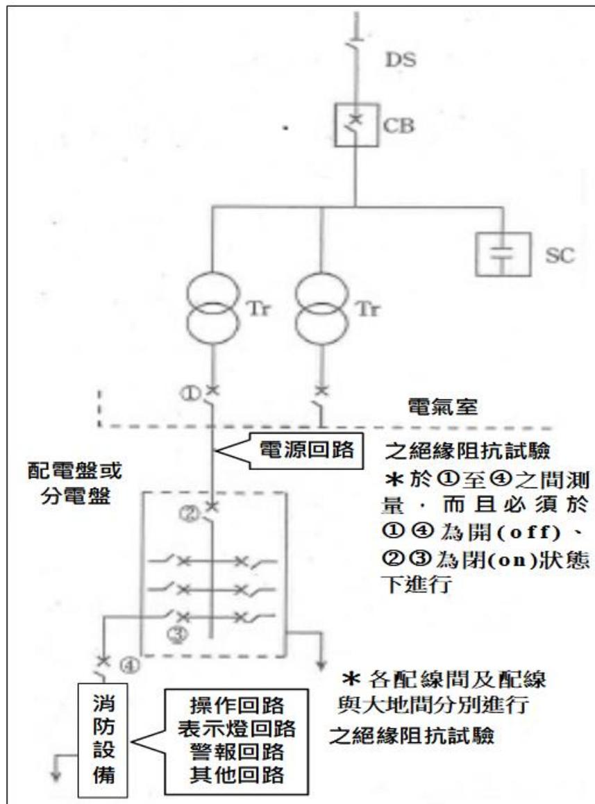
圖 27-1 絕緣阻抗試驗測量位置圖
