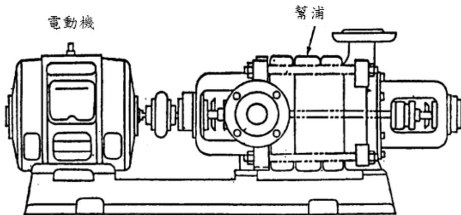
圖 2-3 加壓送水裝置（幫浦方式）圖例
