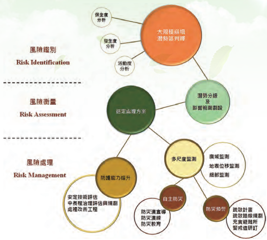
圖 4-16 氣候變遷下大規模崩塌防減災計畫第一期執行流程圖
