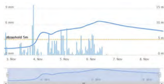
圖 4-86 「貝里斯城市韌性防災計畫」於 San Ignacio 市區架設水文氣象測站即時監控水位以及天候的變化，並建置預警系統平台成功預測淹水範圍
