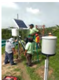
圖 4-86 「貝里斯城市韌性防災計畫」於 San Ignacio 市區架設水文氣象測站即時監控水位以及天候的變化，並建置預警系統平台成功預測淹水範圍
