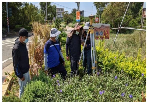
衛星定位、精準可靠-運用 E-GNSS 辦理圖根補建，提升測量精度，加速複丈處理。
