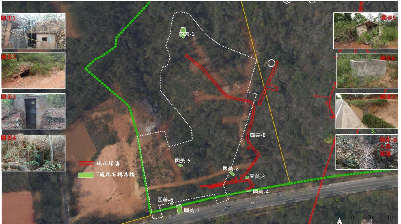
圖 貳-9 透地雷達探測疑似坑道位置試掘工程
