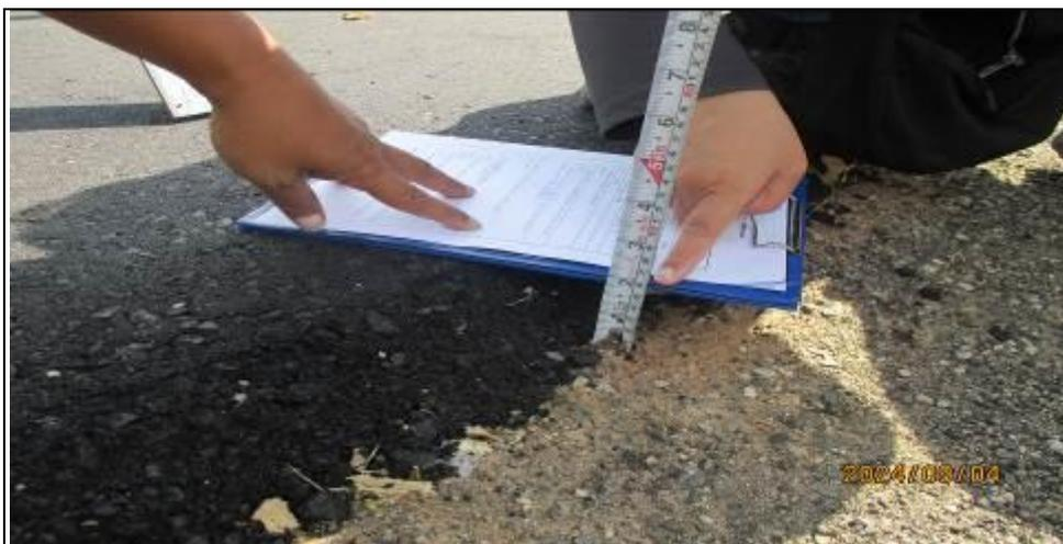
說明：抽測第1區臨時停車場 AC 鋪設厚度，實測 5cm，符合詳細價目表內假設工程項次 23~24 規定。
