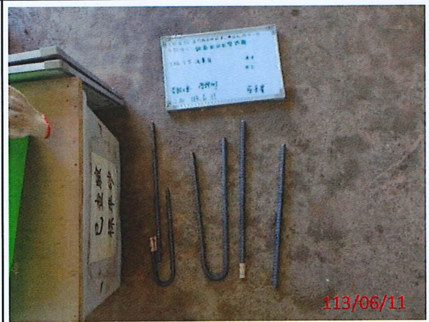
說明：#4、#5鋼筋拉伸、抗彎試驗完成
