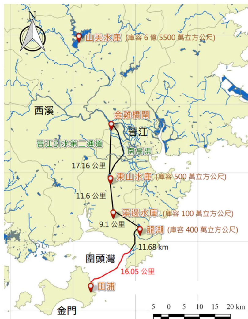
圖 3-3 大陸引水海底輸水管線路線圖
