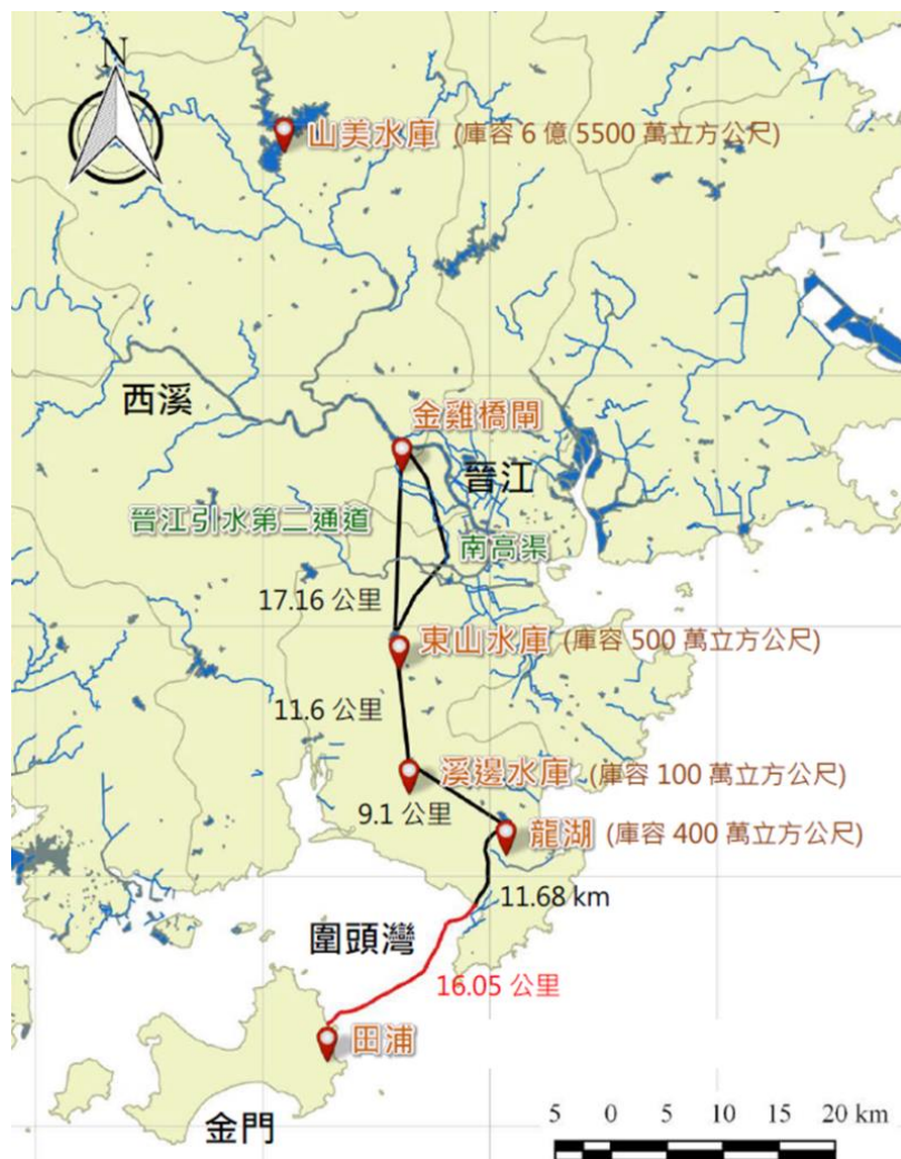
圖 3-3 大陸引水海底輸水管線路線圖
