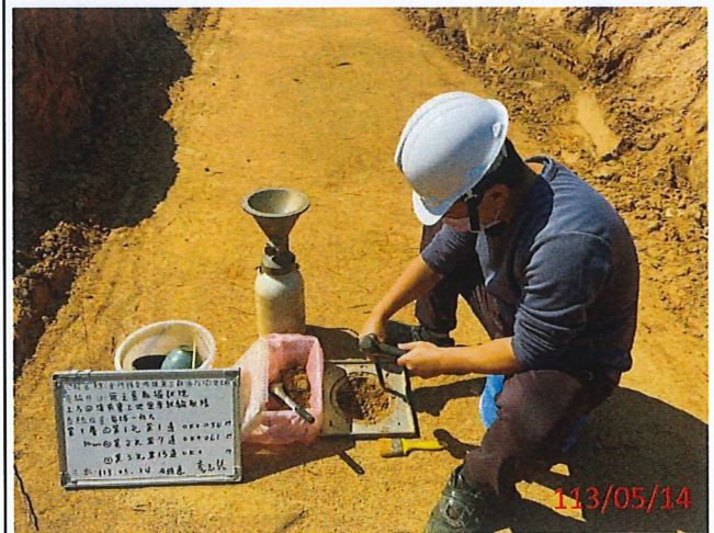
說明：工地密度試驗取樣第2孔第7道OK+061M
