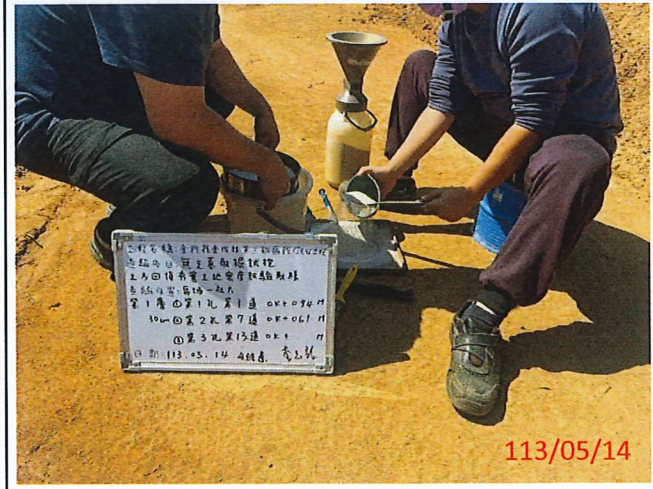
說明：工地密度試驗取樣第3孔第13道OK+036M
