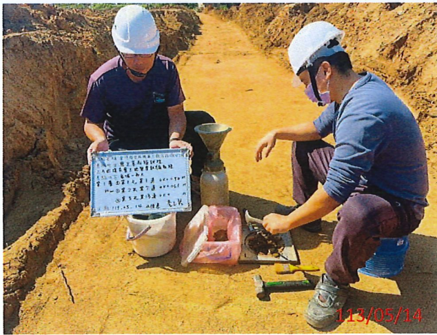
說明：工地密度試驗取樣第2孔第7道OK+061M
