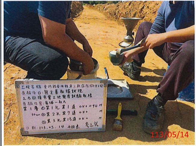
說明：工地密度試驗取樣第1孔第1道OK+094M
