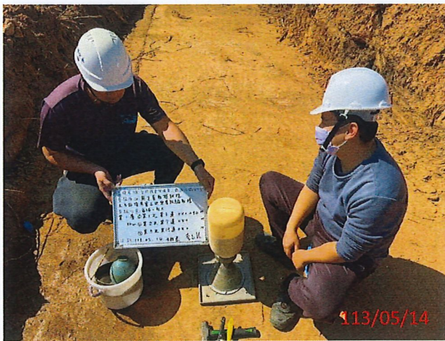
說明：工地密度試驗取樣第1孔第1道OK+094M
