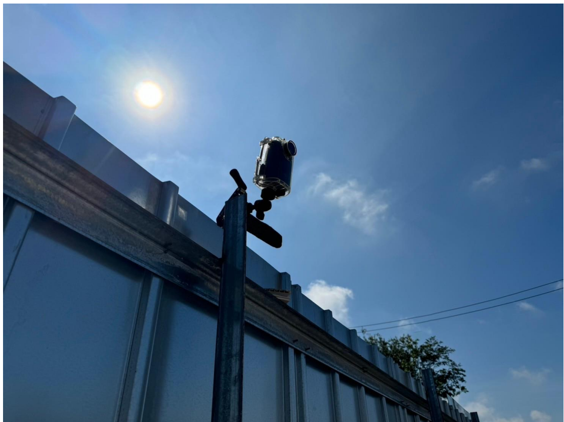
工地即時監控系統
