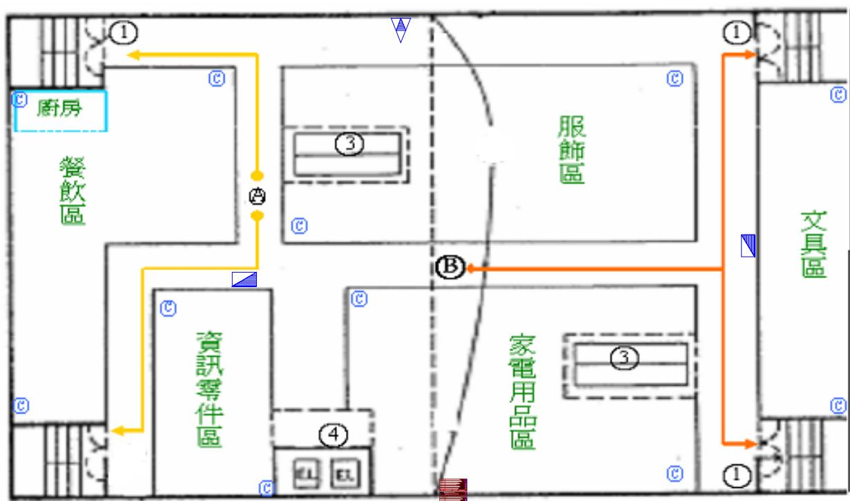
平面圖及逃生避難圖可分別繪製，或如本合併繪製，另實際製作平面圖及逃生避難圖時，每一樓層均應製。
