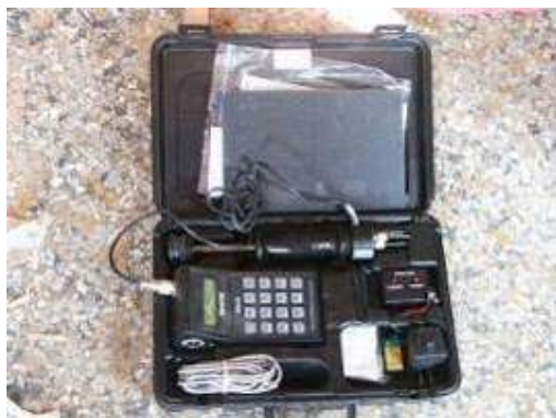
照片 4- 554 電阻式含水率計
