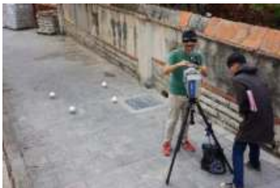
照片 6-79 現場掃瞄設備安裝
