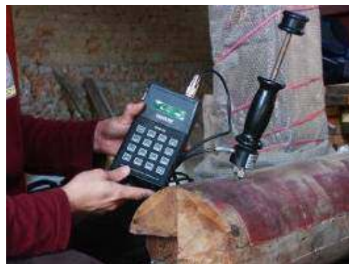
照片 4- 555 以含水率計量測木構件含水率
