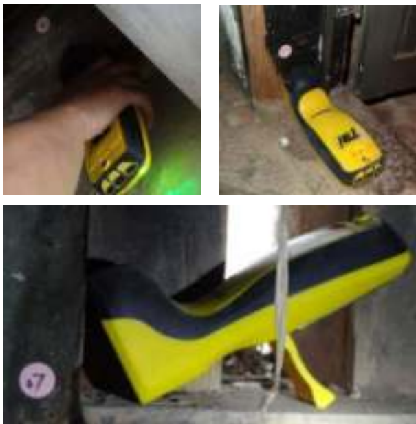
照片 4- 602 非破壞性微波偵測器的偵測方式
