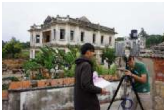
照片 6-90 建築外觀掃瞄作業執行
