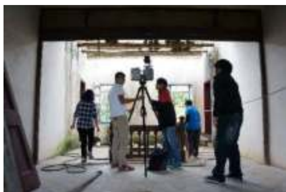
照片 6-96 二樓掃瞄作業
