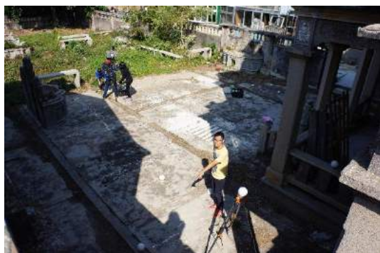
圖 248：測站轉換通視觀測
