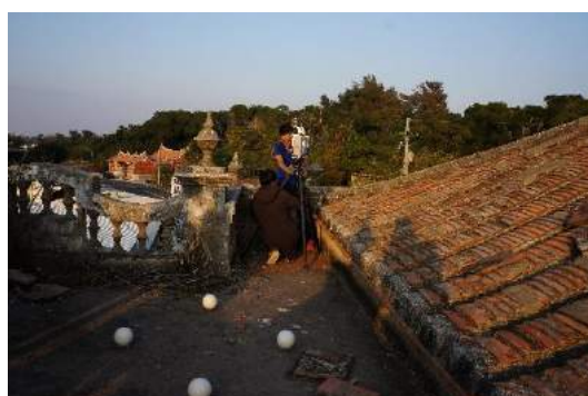
圖 255：主棟建築屋面掃描作業（2）
