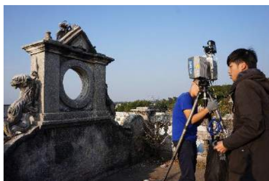
圖 253：主棟建築山牆及屋面掃描作業
