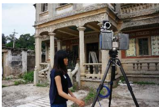
圖 238：建築正面及庭院掃描作業（2）
