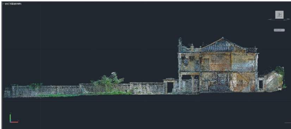
圖 284：點雲圖資匯入 AutoCAD 軟體製作無視角剖立面圖（王金城洋樓）
